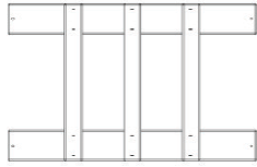
FP1 | PANNEAU DE CLÔTURE - W2A02553 (x1) | 1 1/16"x12"x18 15/16" (27x305x491)
